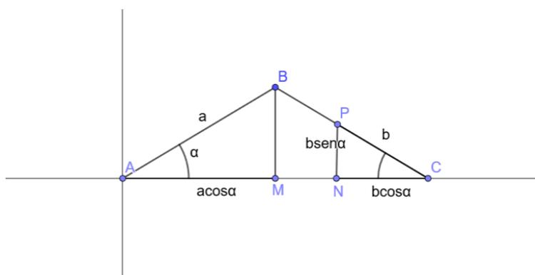
Llamando  $\alpha$  al ángulo que forma el semieje positivo de abscisas con la varilla  $AB$ ; y a partir de los triángulos  $ABM$ ,  $CNM$  y  $CPN$  de la figura, que las coordenadas de  $P(x, y)$  vienen dadas por:
